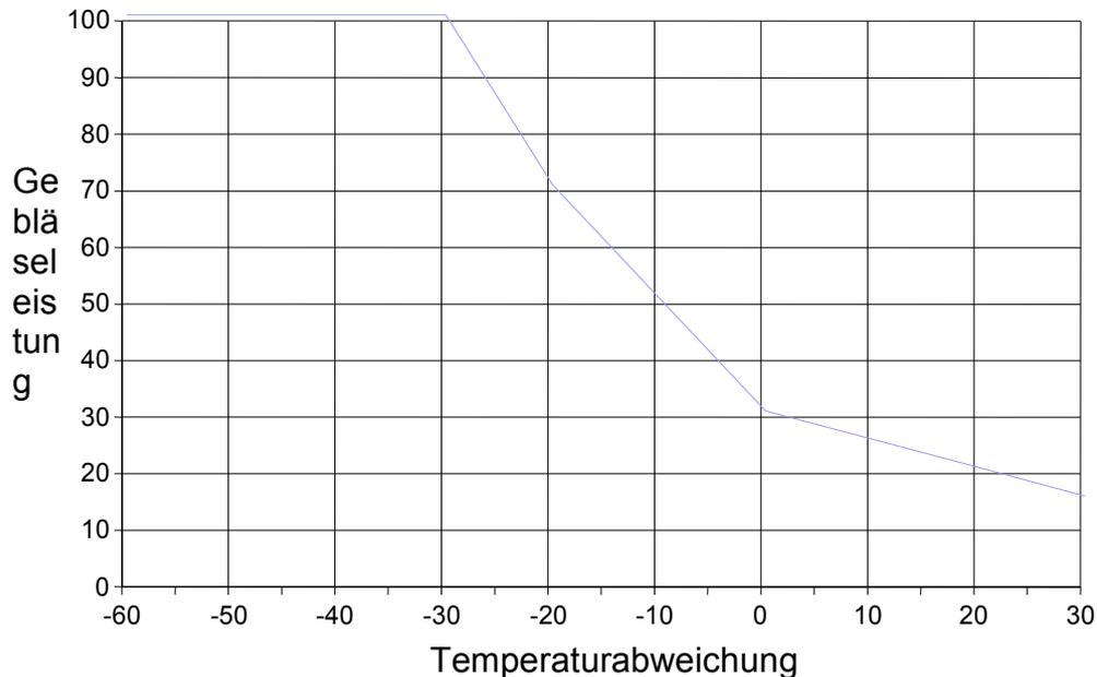
Das Bild zeigt die Regelcharakteristik der Modulationsregelung. In der x-Achse ist die Temperaturabweichung der Kesseltemperatur in Prozent aufgetragen. „-10%“ heißt also beispielsweise, dass die Kesseltemperatur um 10% unter der Solltemperatur liegt. Die Y-Achse zeigt die Gebläseleistung in Prozent.
