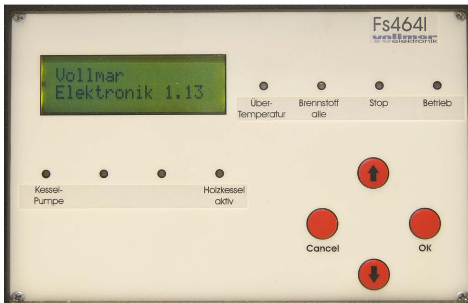
Die Steuerung FS4xx ist mittels vier Tasten(↑,↓,Cancel,OK) über ein zweizeiliges Display zu bedienen.
